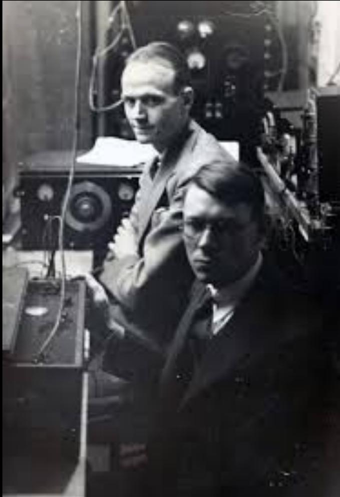
« Ces électrodes étaient ensuite connectées, grâce à 18 mètres de câbles blindés, à un amplificateur à lampes situé dans une chambre insonorisée (séparée du laboratoire où se trouve le chat). L'un des deux chercheurs produisait des sons dans l'oreille du chat, tandis que l'autre, muni d'un récepteur téléphonique, écoutait les signaux amplifiés. »
